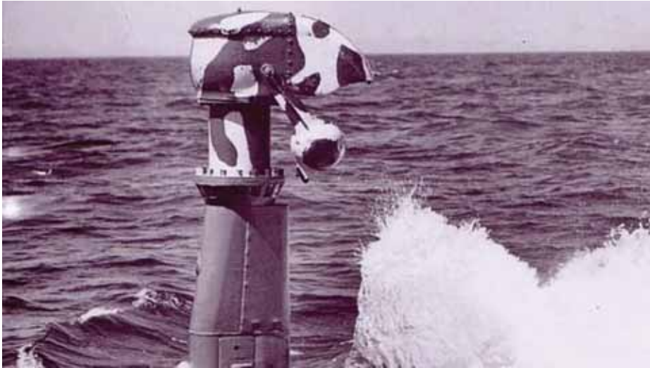
Snorkel de submarino en inmersión funcionando. El ingenio permite a los motores diésel recargar las baterías sin que al submarino le sea preciso emerger.
